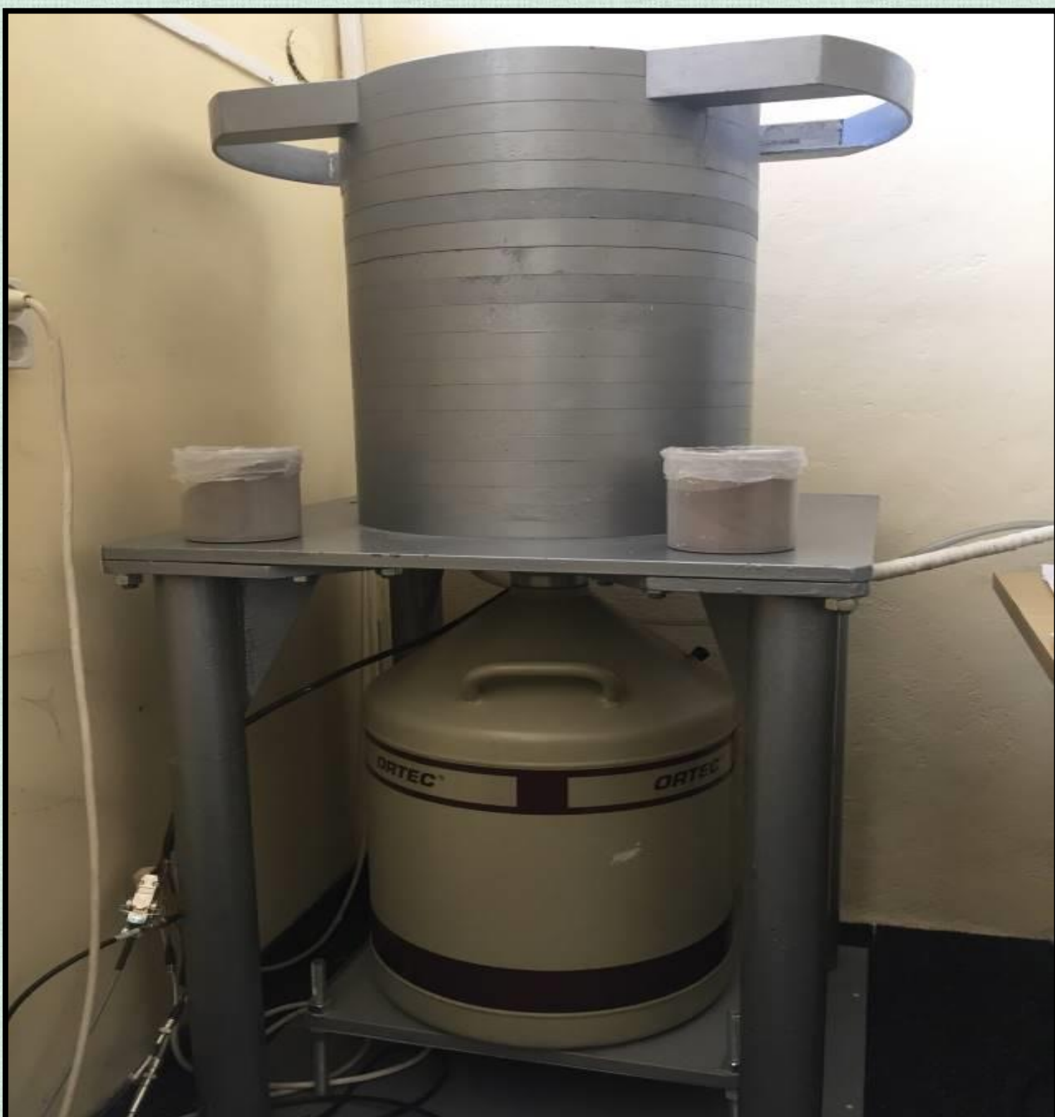
Slika 1. Spoljašnji izgled germanijumskog HPGe detektora koji se nalazi na Institutu za fiziku u Kragujevcu.
